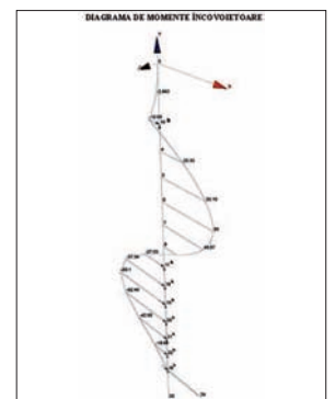
Fig. 6 - Diagrama de momente încovoietoare
